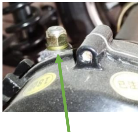
Капачка за гориво Капачка за източване
