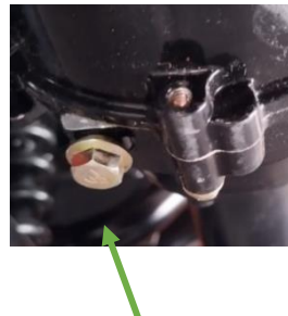
Капачка за гориво Капачка за източване
