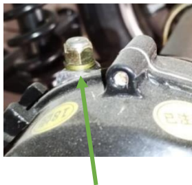
Korek wlewu paliwa Korek spustowy
