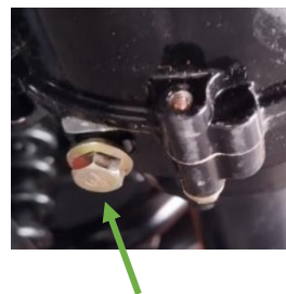
Bouchon de réservoir Bouchon de vidange
