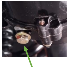
Поклопац за гориво Поклопац за испуштање горива
