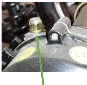
Bouchon de réservoir Bouchon de vidange
